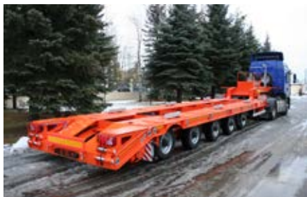
Сверхлегкий полуприцеп массой 8,3 тонны. Разработан SPECPRICEP
