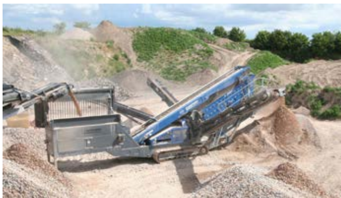
Мобильный грохот KLEEMANN MS 16 D производительностью 350 т/ч
