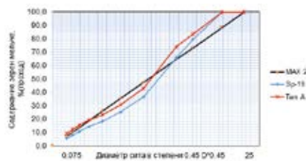
Рисунок 3. Сравнение зерновых составов суперпейв-смеси Sp-19 и стандартной смеси типа А
