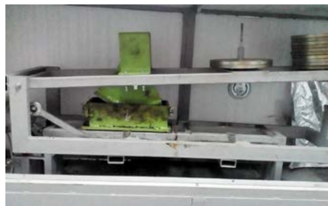
Рисунок 3. Образцы после испытания на устойчивость к появлению пластических деформаций: а) образец серии №1 (без армирования); б) образец серии №2 (армированный БСД)
