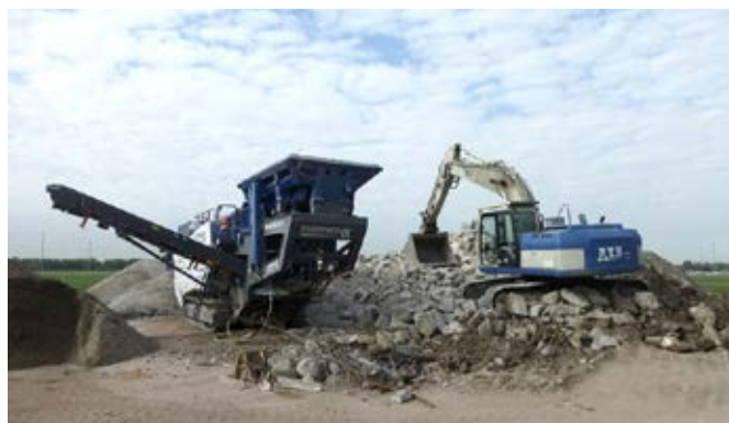
Мобильная роторная дробилка KLEEMANN MR 110 Z EVO 2 производительностью 350 т/ч
