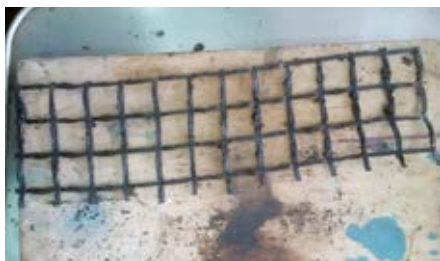
Рисунок 8. Геосетка, извлеченная из разрушенного образца после уплотнения верхнего слоя асфальтобетона
