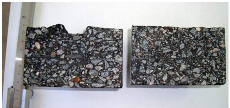
Рисунок 3. Образцы после испытания на устойчивость к появлению пластических деформаций: а) образец серии №1 (без армирования); б) образец серии №2 (армированный БСД)
