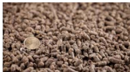
Гранулы полифункциональной полимерной системы имеют размеры от одного до двух сантиметров (для сравнения сверху лежит монета 20 евроцентов)
