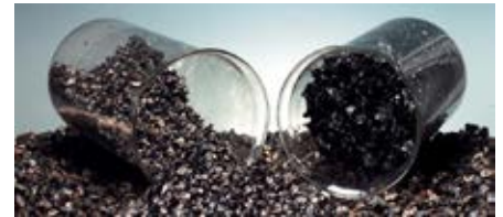
Стандартная дозировка адгезионной добавки составляет 0,1–0,3% от массы вяжущего
