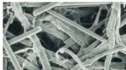
Волокна используются для армирования асфальтобетонной смеси
