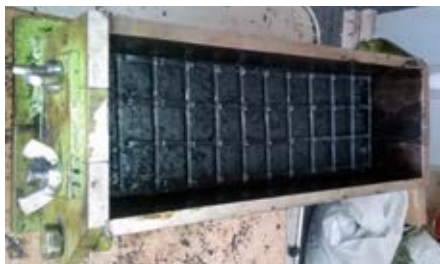
Рисунок 6. Геосетка, уложенная на нижний слой асфальтобетона
