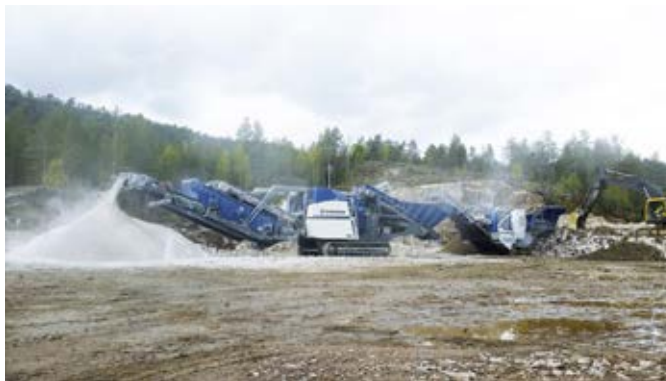
Мобильная конусная дробилка KLEEMANN MCO 9 S EVO производительностью 245 т/ч
