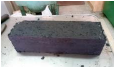
Рисунок 7. Двухслойный образец, содержащий геосетку
