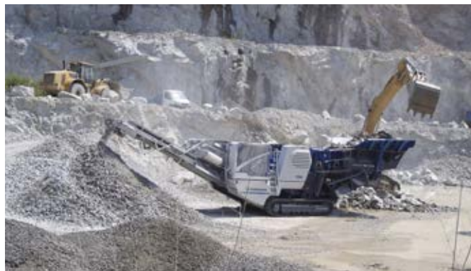
Мобильная щековая дробилка KLEEMANN MC 110 Z EVO производительностью 330 т/ч
