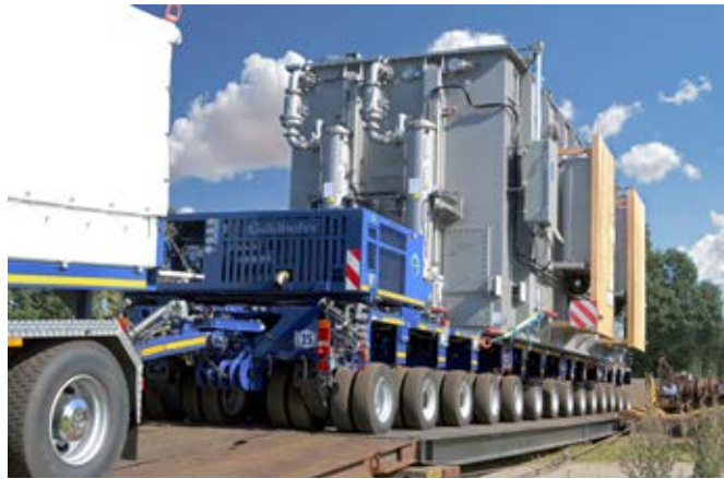
Модуль Goldhofer с шестью осевыми линиями, оснащенный ассистирующей системой ADDrive
